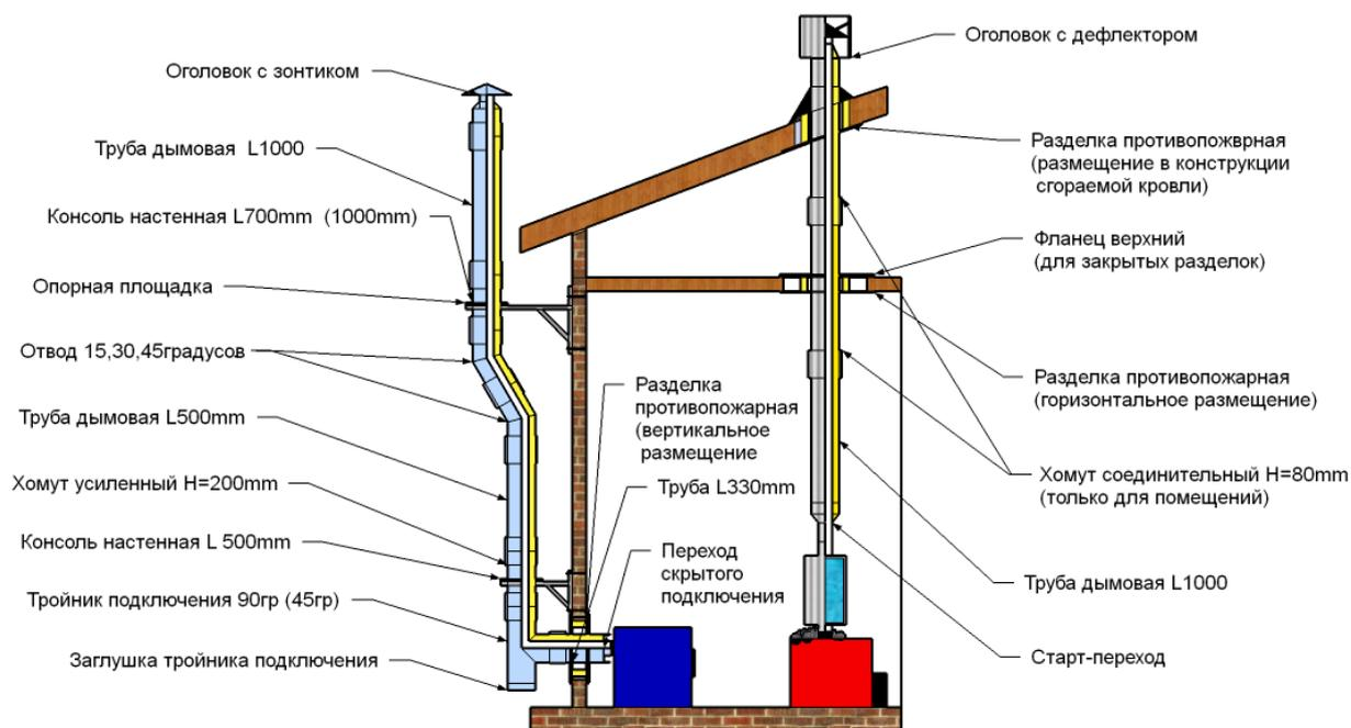
Рис. №7 - схема монтажа дымоходной системы «Вермилоджик»
